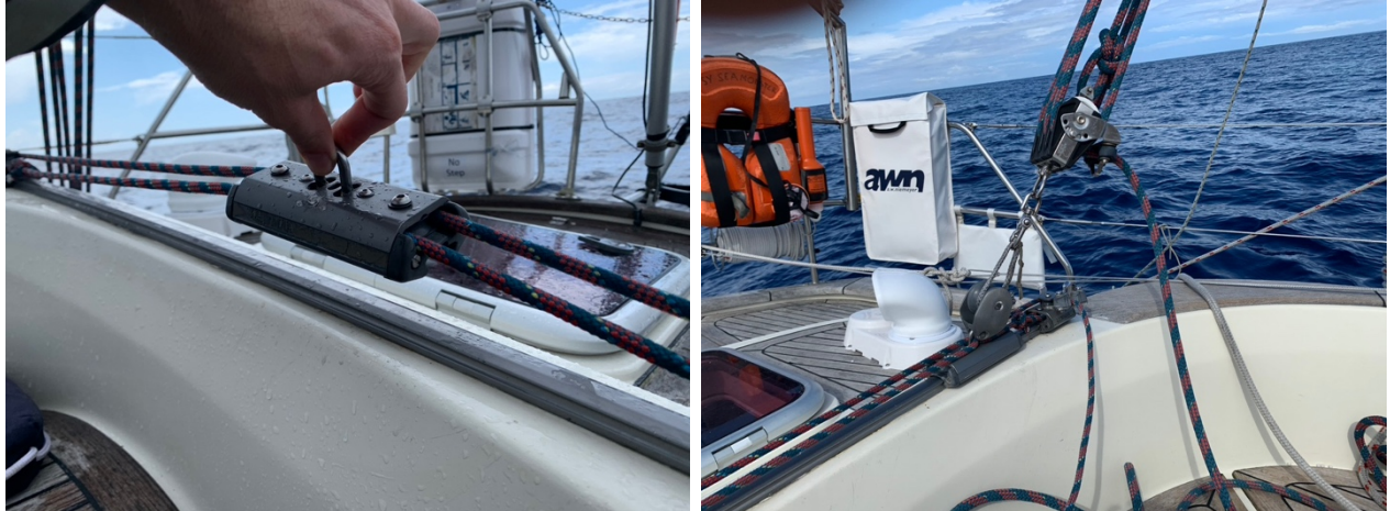
Bild 9 Links: Der Travellerschlitten hat sich von der Schiene gelöst. Rechts: Ersatztravellerschlitten aus ausrangiertem Genuaschotblock und Softschäkel.
